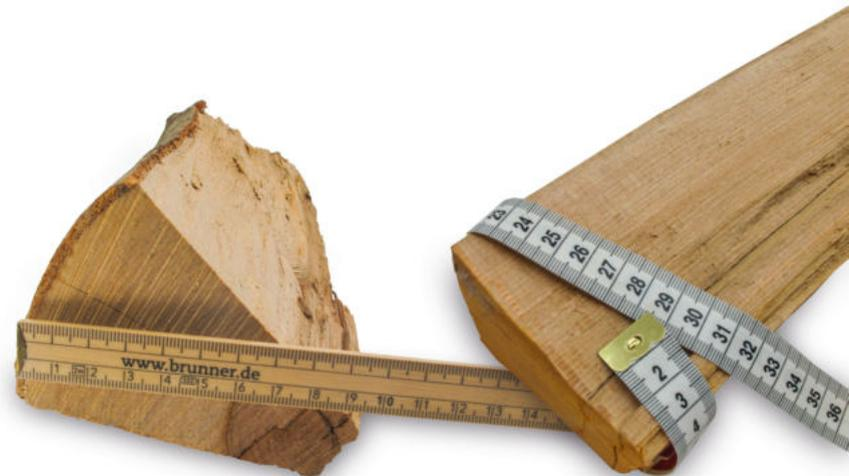
Ein Scheitumfang von 25 cm entspricht einem Scheitdurchmesser von etwa 9 cm
