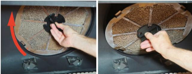
Lockern und entfernen der Katalysatoreinheit mit Hilfswerkzeug
