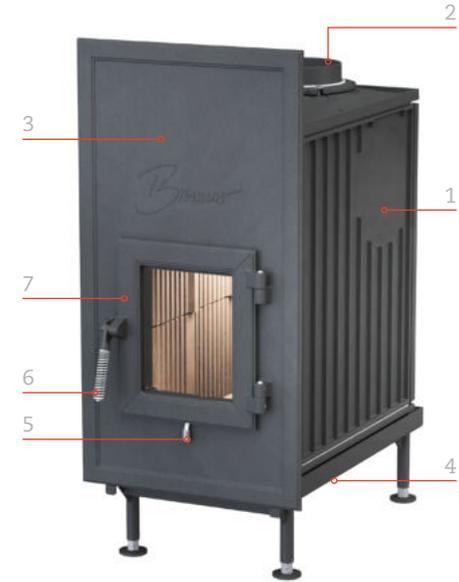
1 Korpus 2 Heizgasstutzen (Heizgasanschluss) 3 Frontplatte (790x420 mm, 830x480 mm, 895x480 mm) 4 Verbrennungsluftstutzen 5 Verbrennungsluft-Stellelement (Luft-schieber) 6 Türgriff 7 Tür mit Scheibe
