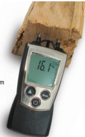
Der Wassergehalt im Holz lässt sich mit einem Holzfeuchte-meßgerät schnell ermitteln.
