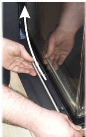
Abb. 5: Schließen der Eck-Feuerungstür links
