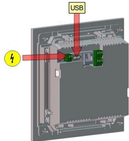
5. Beim Starten des Bedienteils wird ein aktuelles Update erkannt und geladen. Das System führt einen automatischen Neustart aus und beginnt mit dem Ladevorgang (Anzeige „rote Welle“; danach erscheinen „Ladebalken“) des Updates. Das erfolgreiche Aufspielen des Updates wird durch die Meldung „remove USB-Stick and reboot“ angezeigt.
