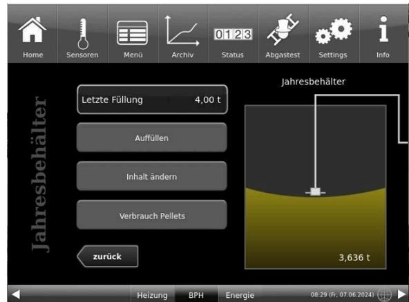
Abbildung 9: Display bei eingebautem Pellet-Maulwurf-System (Beispiel mit leeren Jahresbehälter)
