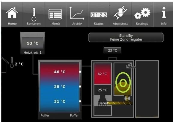
Abbildung 7: Schaltfläche zum Befüllen des Tagesbehälters
