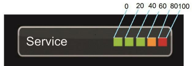
Abbildung 30: Display: Wartungsintervalle
