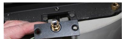
Abb. 55: Einsetzen des Türkontaktschalters in Quersteg Front
