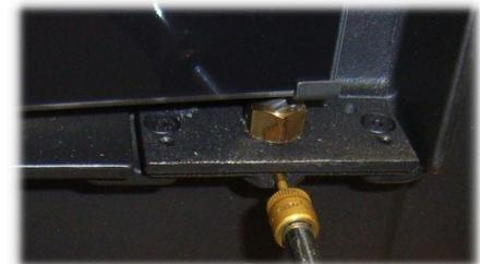
Abb. 22: Verdrehsicherung lösen
