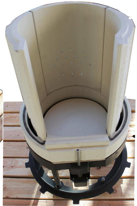
Abb. 16: Brennraumwand komplett
