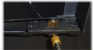
*Abb. 27: Sichern der Gewindehülse*
