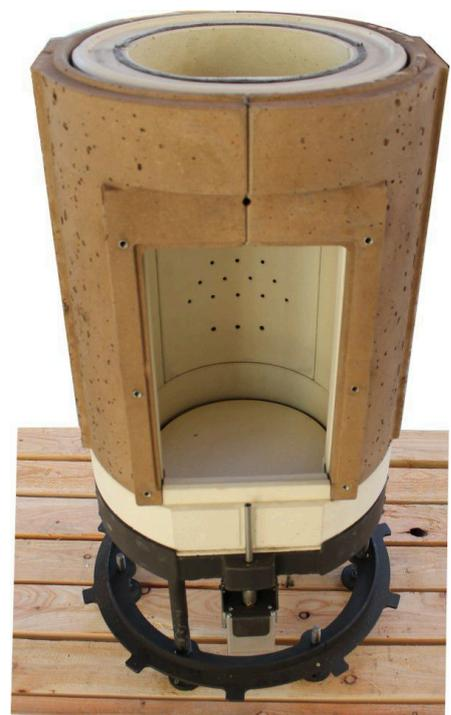
*Abb. 19: Außenschalen montiert und ausgerichtet*
