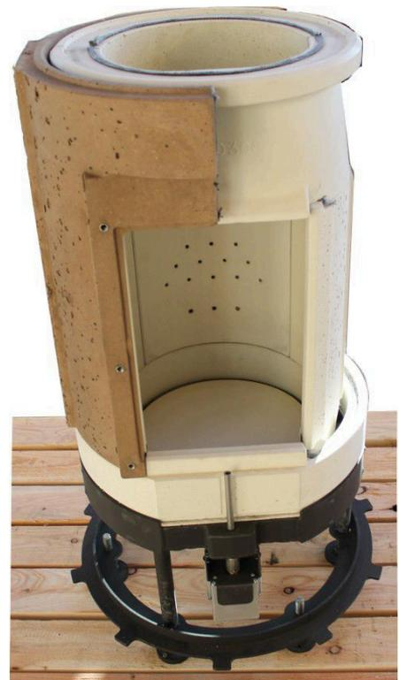
*Abb. 18: Innenring vorn und Außenschale links aufgesetzt*
