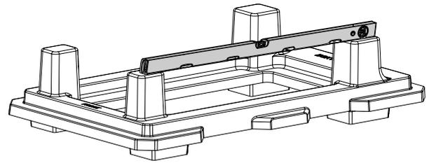
Abb. 7: Grundplatte ausrichten
