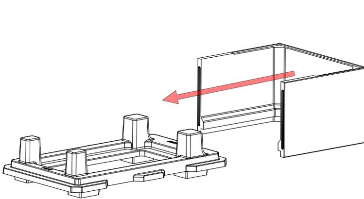
Abb. 8: Hinteren Grundring einschieben
