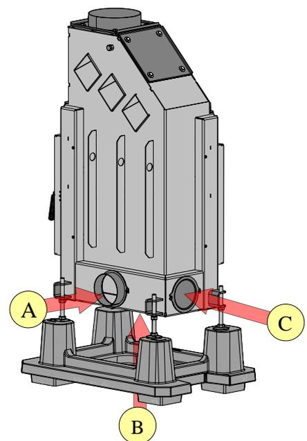
zum Beispiel Verbrennungsluftanschluss hinten (Position A) - dafür ist eine Aussparung im hinteren Stein (BSK12000-003) notwendig:
