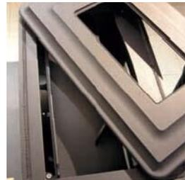
vorne in Richtung Kamintür schieben. Anschließend Reinigungsplatte nach oben drücken und herausnehmen. Nach der Reinigung Feuerraumlenkung wieder an die Rückwand zurückschieben.
