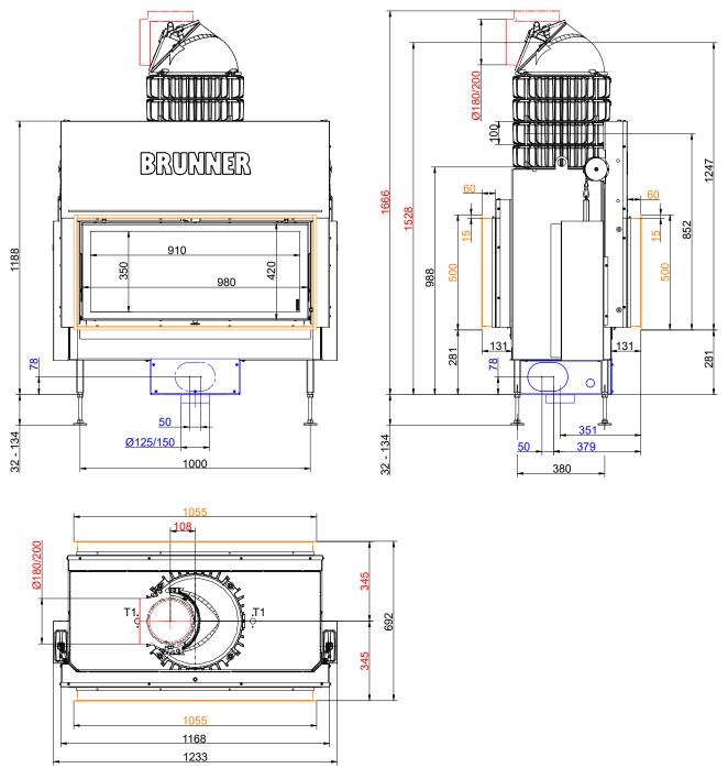
... Schiebetür/Kipptür mit Blendrahmen und Wärmetauscherringe Guss + Gusskuppel
