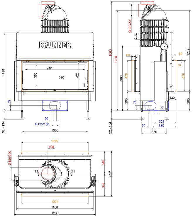
... Schiebetür/Kipptür mit Anbaurahmen und Wärmetauscherringe Guss + Gusskuppel
