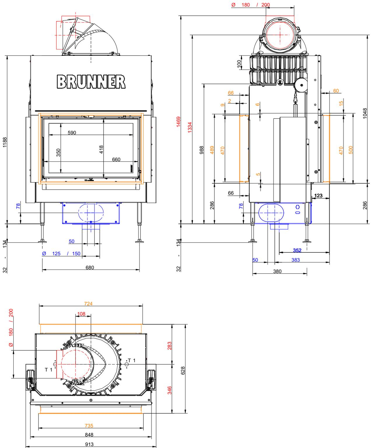
... Schiebetür/Drehtür mit Blendrahmen und Wärmetauscherringe Guss + Gusskuppel
