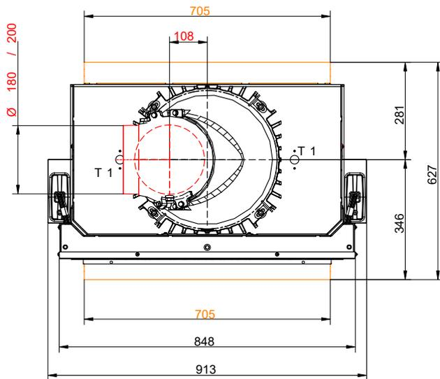
... Schiebetür/Drehtür mit Anbaurahmen/Anbaukante und Wärmetauscherringe Guss + Gusskuppel
