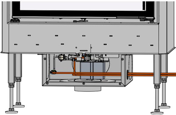
Abb. 4: Kabelführung rechts
