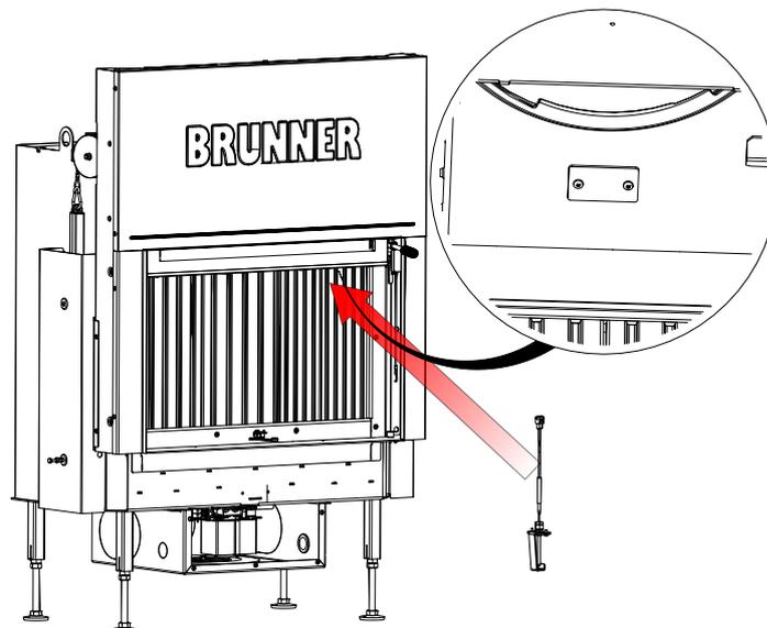
Varianten Kabelführung - Thermoelement: rechts bzw. links
