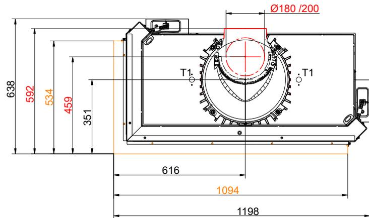
... links mit Anbaurahmen und Wärmetauscherringe Guss + Gusskuppel
