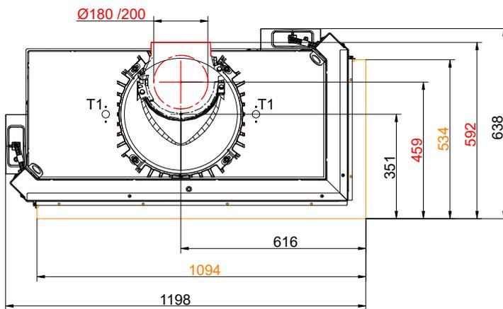
... rechts mit Anbaurahmen und Wärmetauscherringe Guss + Gusskuppel
