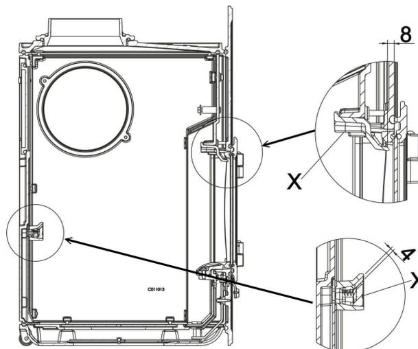
Abb. 1: Verbrennungslufteinstellung
