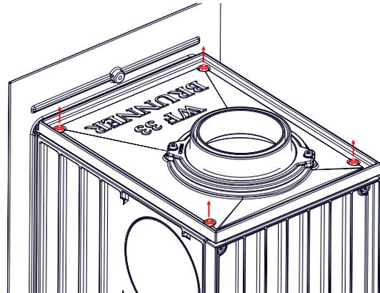
Abb. 4: Schrauben Deckel demontieren
