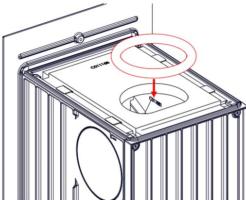
Abb. 9: Dichtung auflegen
