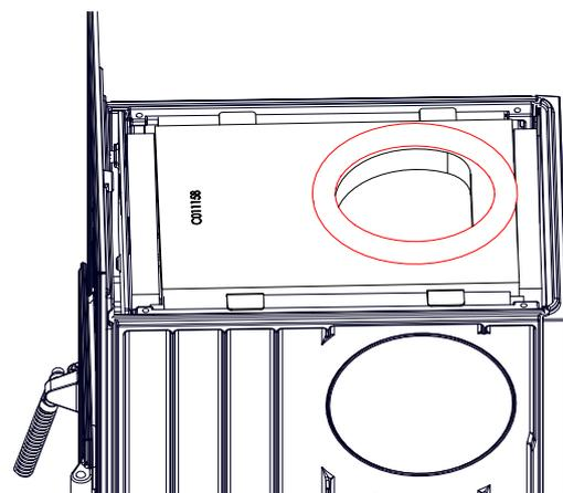
Abb. 10: Dichtung aufgelegt
