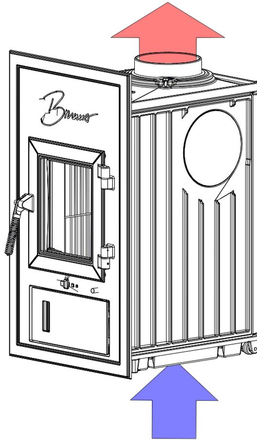
**MONTAGE DES VERBRENNUNGSLUFTSTUTZENS (OPTIONAL)**
