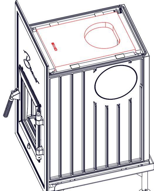
Abb. 8: Deckel ISO-Brennkammer eingelegt
