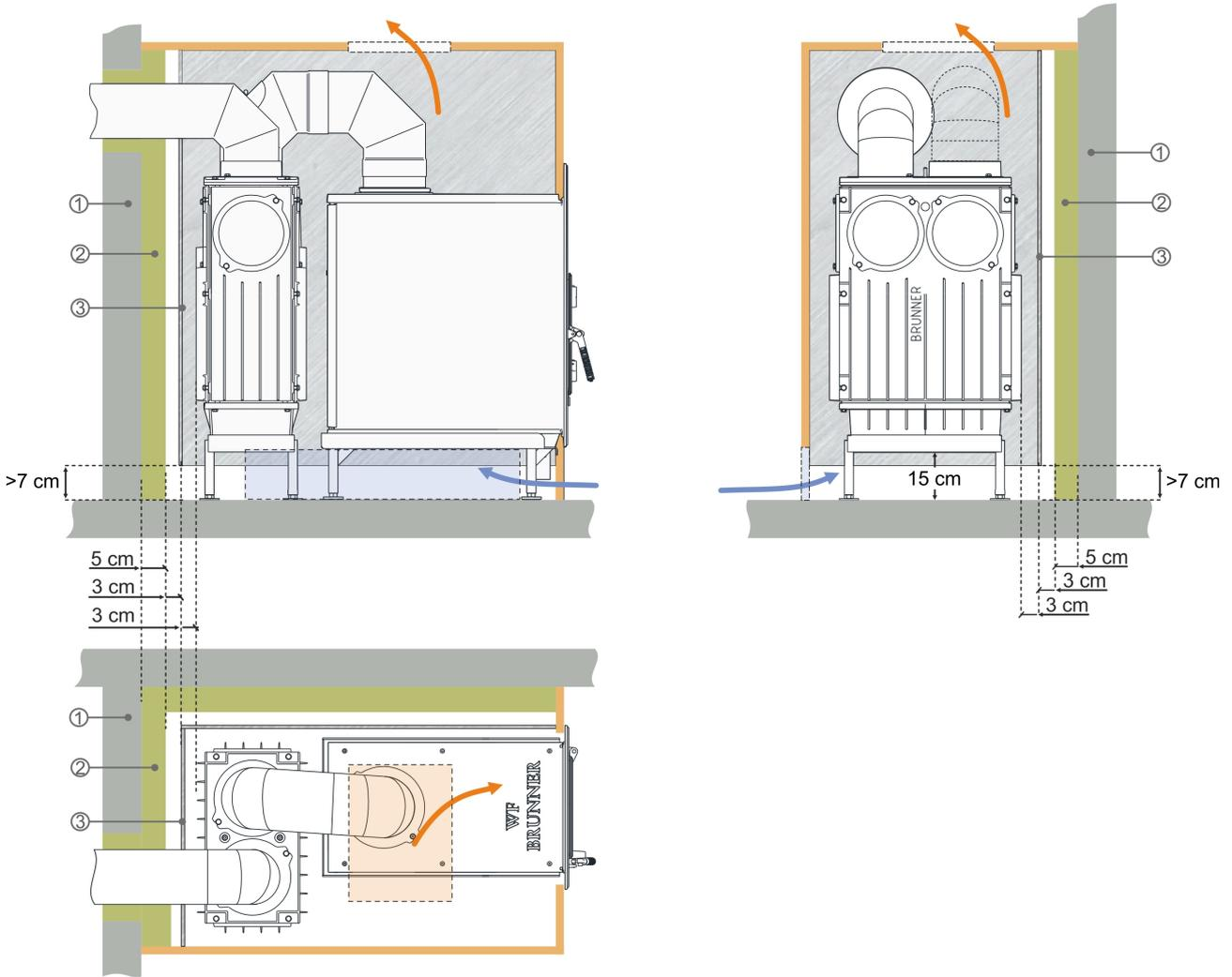
**Alternative Wärmedämmung mit Hitzeschutzblech<sup>x)</sup> vor Dämmschicht <sup>xx)</sup>.**
