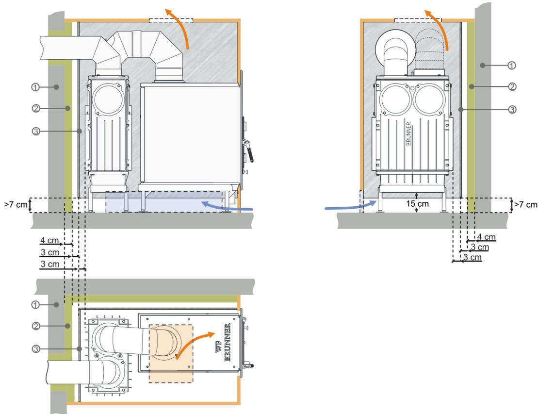
Wärmedämmung mit Hitzeschutzblech<sup>x)</sup> vor Dämmschicht <sup>xx)</sup>.
