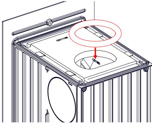
Abb. 13: Dichtung auflegen
