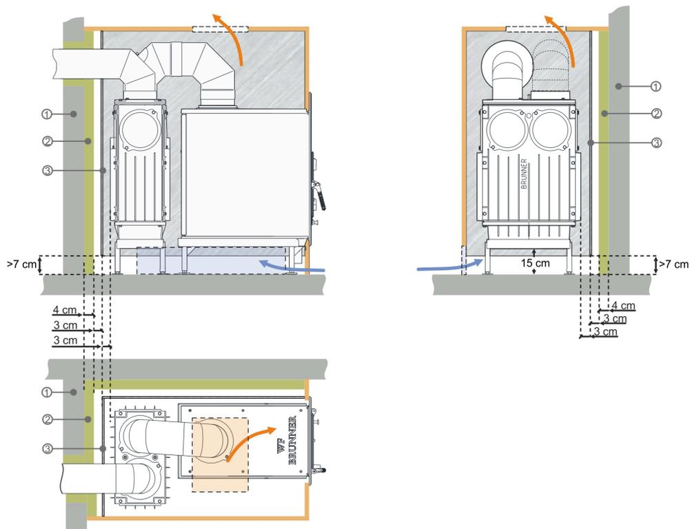
**Alternative Wärmedämmung mit Hitzeschutzblech<sup>x)</sup> vor Dämmschicht<sup>xx)</sup>.
