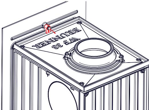
Abb. 7: Klemmbügel demontieren
