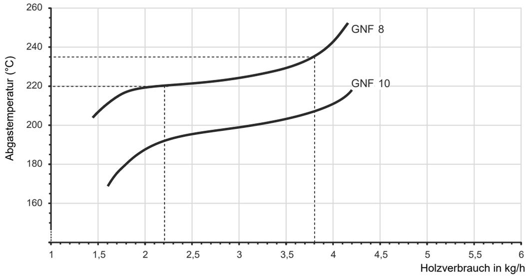
... Auslegungdiagramm mit metallischer Nachheizfläche
