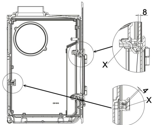
Abb. 5: Verbrennungslufteinstellung
