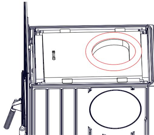
Abb. 14: Dichtung aufgelegt
