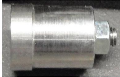
Abb. 5: Scharnierhülse mit Konternmutter
