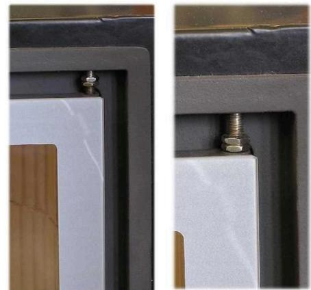
Abb. 3: Türanschlag lösen
