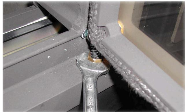
Abb. 1: Verstellen der Messingmutter
