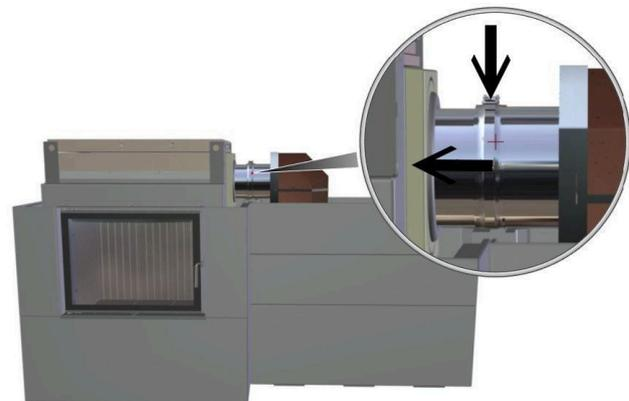
*Abb. 40: Innenrohr des MSS-Adapters in Anschlussstein einführen, mit mitgelieferter Dichtung abdichten und Bügel schließen*
