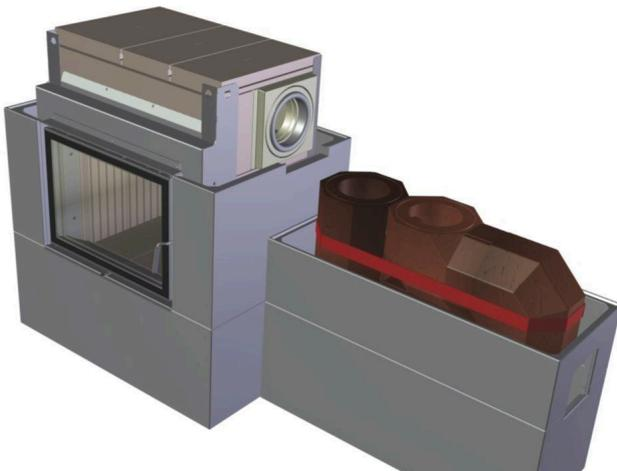
*Abb. 37: Zweite Reihe setzen und sichern und zweiten Betonring auflegen.*
