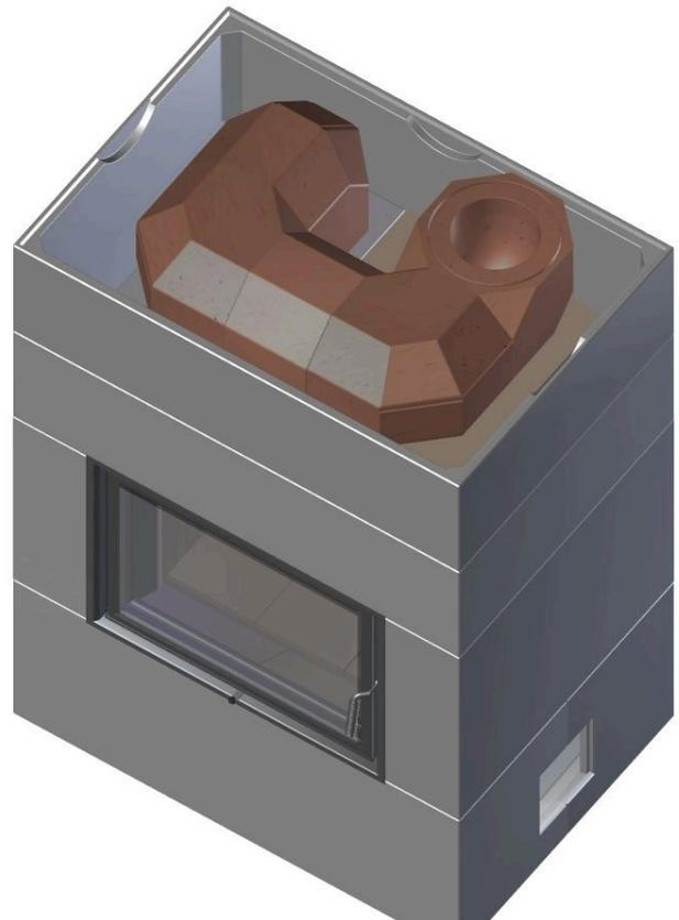
*Abb. 18: Erste Ebene MSS gesetzt*
