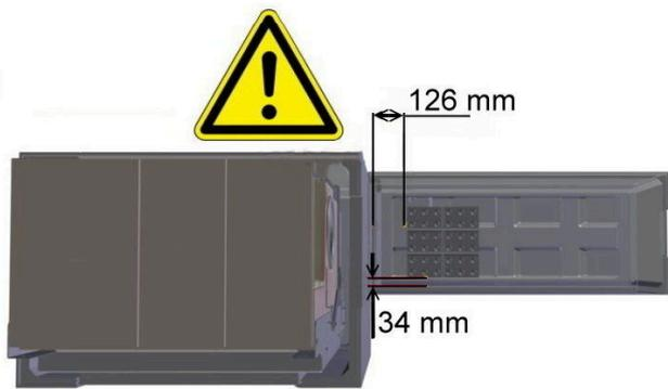
Abb. 31: Sockelstein ausrichten
