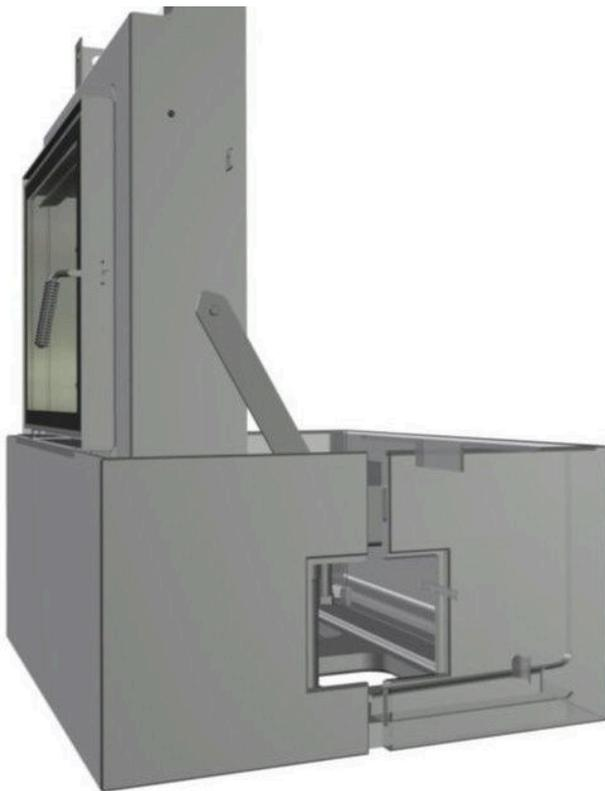
*Abb. 27: Zweiten Grundring setzen*
