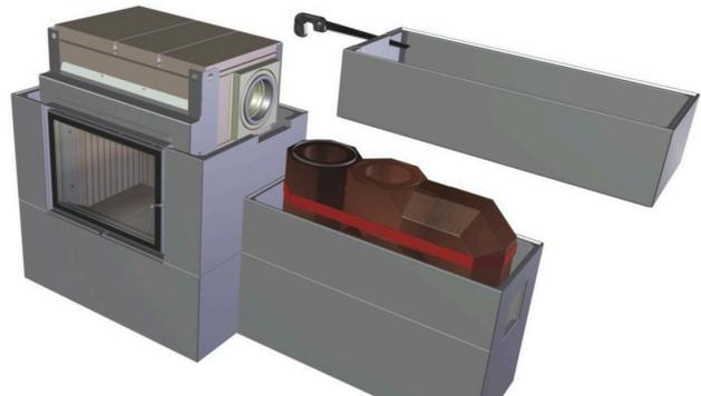
*Abb. 38: Dritten Betonring setzen und ausschneiden für MSS-Adapter*
