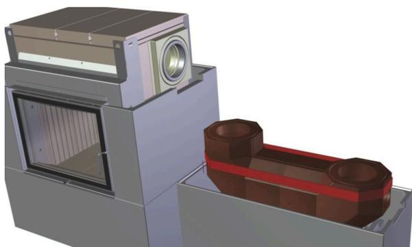
Abb. 35: Untere Reihe setzen und mit Spanngurt sichern.
