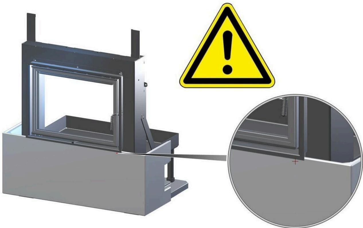
Abb. 12: Grundring 2 setzen
