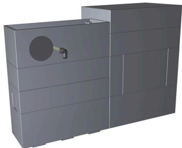
*Abb. 42: Obere Ringe setzen und Ausbrand ausschneiden. Deckel aufsetzen.*
