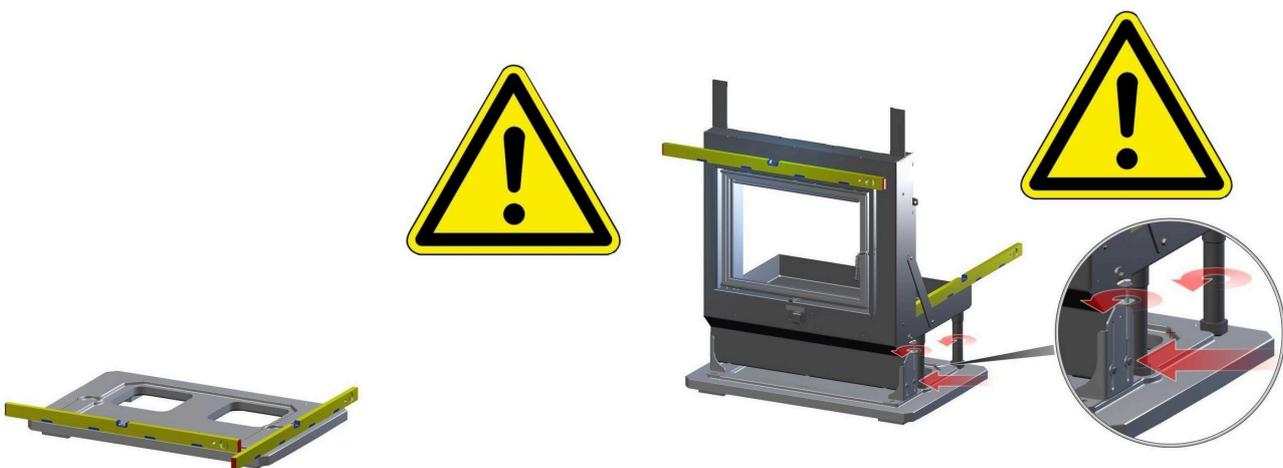
Abb. 23: Bodenplatte ausrichten
