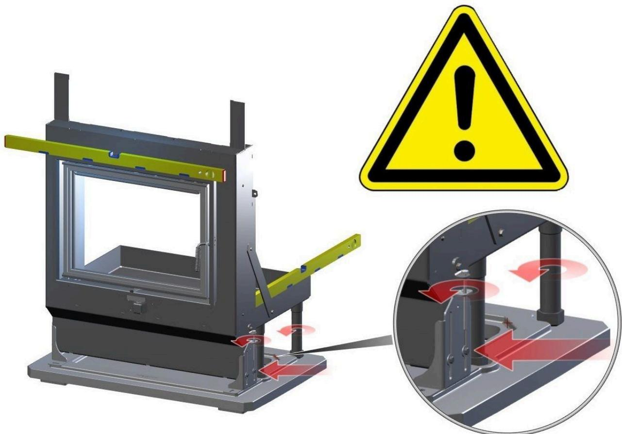
Abb. 10: Grundofentür mit Tragrahmen ausrichten
