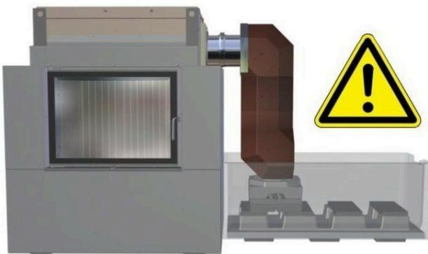
Abb. 33: Bodenisolerstein setzen und Testaufbau trocken um Anschlusshöhe zu überprüfen.
