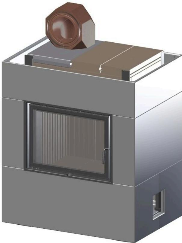
*Abb. 17: Ersten MSS-Bogen setzen*
