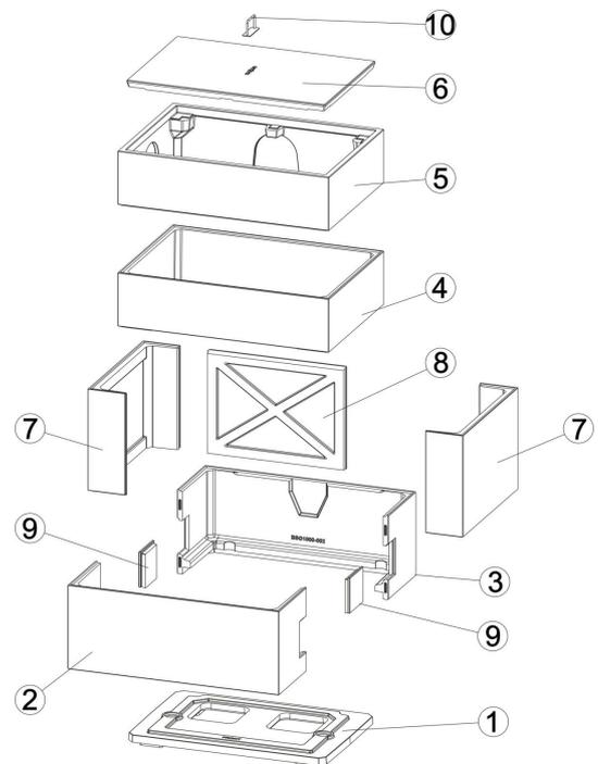
Abb. 3: Bauteile der Betonverkleidung GOF
