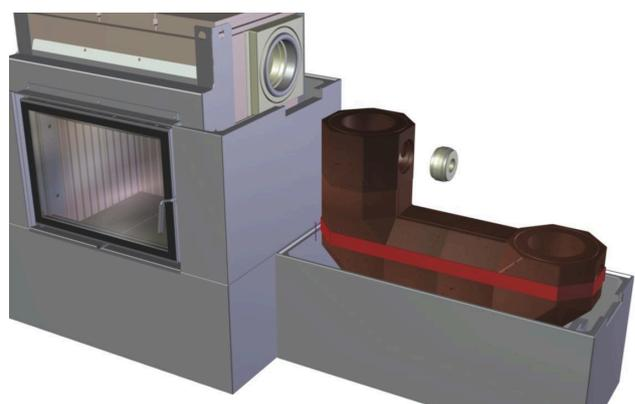
Abb. 36: Erstes Element der Reihe 2 setzen und Bypassselement einsetzen.
