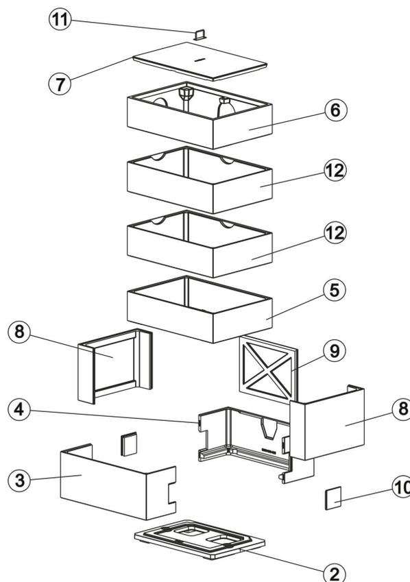
Abb. 1: Bauteile der Betonverkleidung
