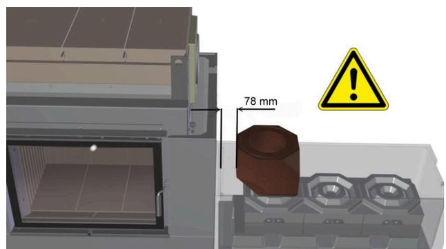
Abb. 34: Bodenisolersteine trocken setzen und ersten Bogen ausrichten
