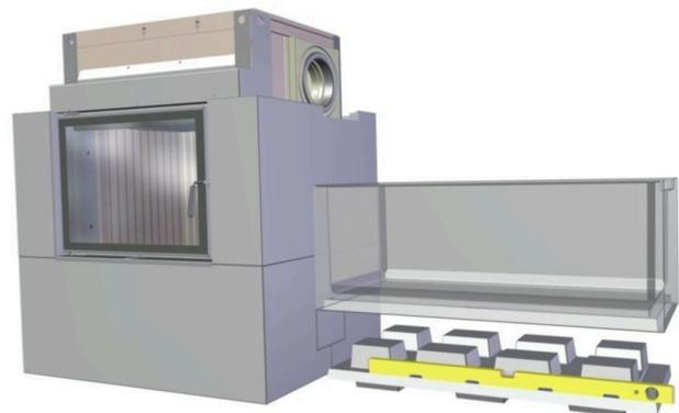
*Abb. 30: Grundplatte und ersten Betonring für den Speicherblock setzen. Die Rückseiten der Betonteile bündig setzen.*
