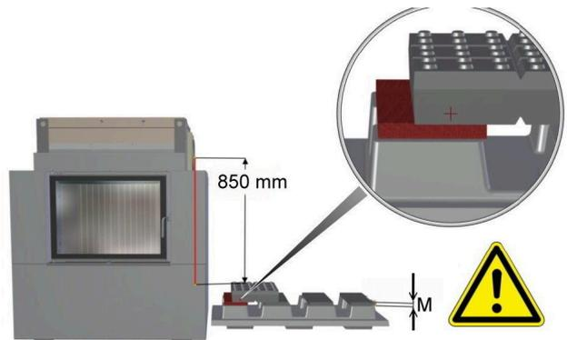
Abb. 32: Sockelsteine auf errechnetes Mörtelbett setzen
