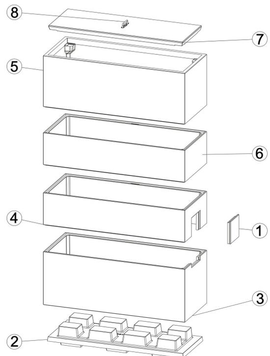
Abb. 4: Bauteile der Betonverkleidung MSS
