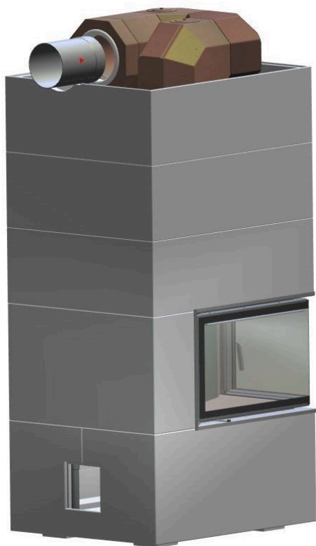
Abb. 20: Zweite Ebene MSS und zweiten Aufsatzring aufsetzen
