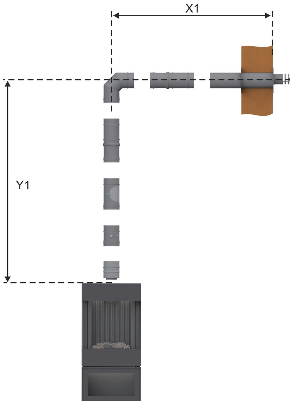
**LAS Nr. 9: Außenwandanschluß D=100/150 mm (C<sub>11</sub>; Abgasstutzen D=100/150 mm)**
