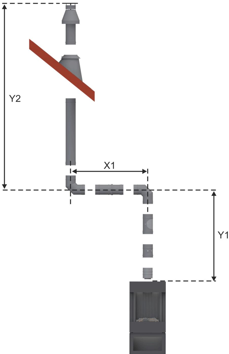
**LAS Nr. 3: vertikale Rohrführung D=100/150 mm mit horizontalem Abschnitt und Abgasmündung über Dach (C<sub>31</sub>; Abgasstutzen D=100/150 mm)**
