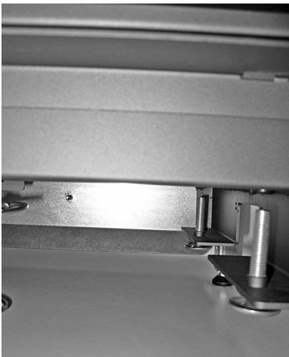
Abbildung 5: Stellfüße von der Unterseite des Geräts gesehen
