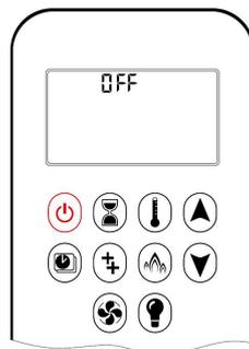
Bei der basic control gas Fernbedienung entspricht dies der Taste **OFF**.
