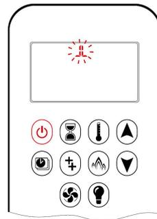
Bei der basic-control gas Fernbedienung entspricht dies der Taste **ON**.
