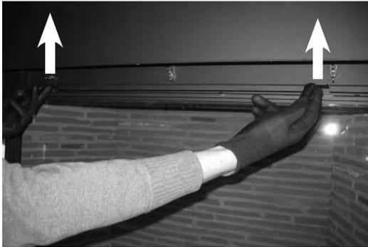
6. Unterstützen Sie die Scheibe so dass diese nicht nach vorne kippen kann, und schieben Sie den Stahlstreifen (den Streifen der mit den Flügelmuttern befestigt ist) nach oben. Über dem Streifen sehen Sie einen Magneten. Dieser Magnet hält den Streifen fest, nachdem dieser nach oben geschoben wurde. Die Scheibe kann jetzt entfernt werden, indem sie etwas angehoben, in die Ecke geschoben und nach außen gedreht wird.
