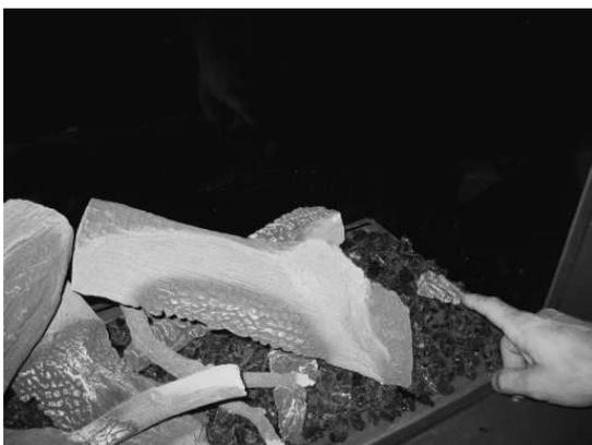
17. Verteilen Sie die mitgelieferten Keramikstücke (diese können bei Bedarf gebrochen werden) auf dem Gitterrost.
