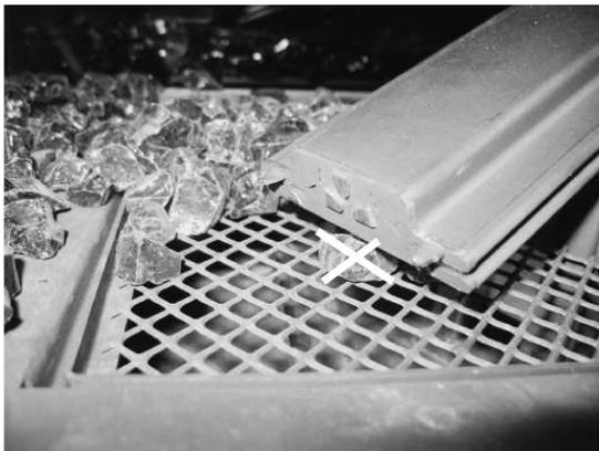
28. Platzieren und montieren Sie den Brenner rechts. Drücken Sie den Brenner fest herunter und bringen Sie die Befestigungsbolzen an.
