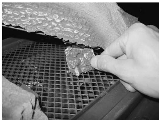
6. Legen Sie das verkohlte Stück Nr. 24 (340029) unter den linken Brenner, um die Brennerbefestigung.
