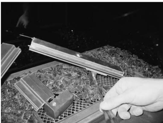
29. Platzieren und montieren Sie den Brenner mittig. Drücken Sie den Brenner fest herunter und bringen Sie die Befestigungsbolzen an.
