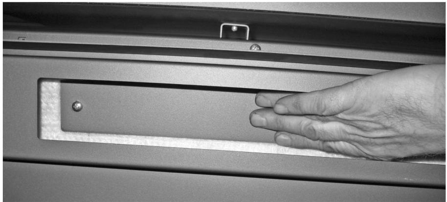
Kontrollieren Sie die Dichtung der Überdruckluke. Die Dichtung kann ausgetauscht werden, indem Sie die Luke anheben, kippen und aus der Öffnung herausnehmen.
