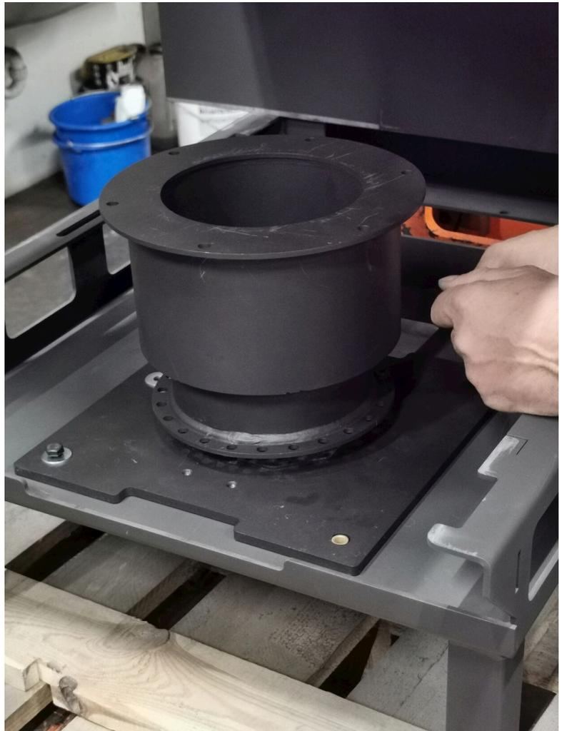
Bei den Varianten mit EAS / EOS muss nun die Türkontaktleitung in das Standrohr eingezogen werden. Zuvor müssen die vier Kabelschutzelemente (K) aus Silikon zum Schutz der Türkontaktleitung (T) auf die Speichen der Drehmechanik aufgezogen werden.
