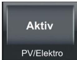
Der E-Stab ist eingeschaltet, (die Einstellung der **Aktivierung** ist auf **Bedarf** und **Leistung max.** = übernommene Leistung vom E-Stab) und er wird nicht von der Photovoltaikanlage versorgt, oder der Energie-PV-Anteil ist unbekannt.
