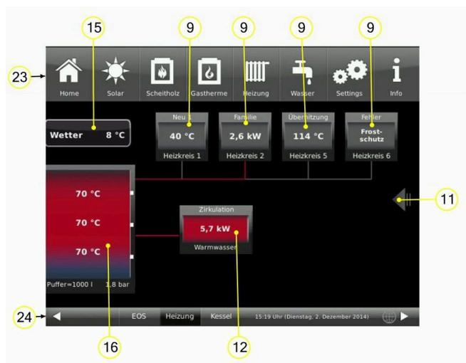
**Abbildungsbeispiel 2:** eine BHZ 3.0, welche als Energielieferanten eine BRUNNER-Wärmepumpe green hat. Energieabnehmer ist 1 Heizkreis und die Warmwasserstation. Zusätzlich ist die Kühlfunktion der Wärmepumpe aktiv.
