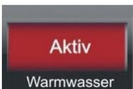
= es wird Brauchwasser angefordert, es wird ein Warmwasserhahn betätigt;
