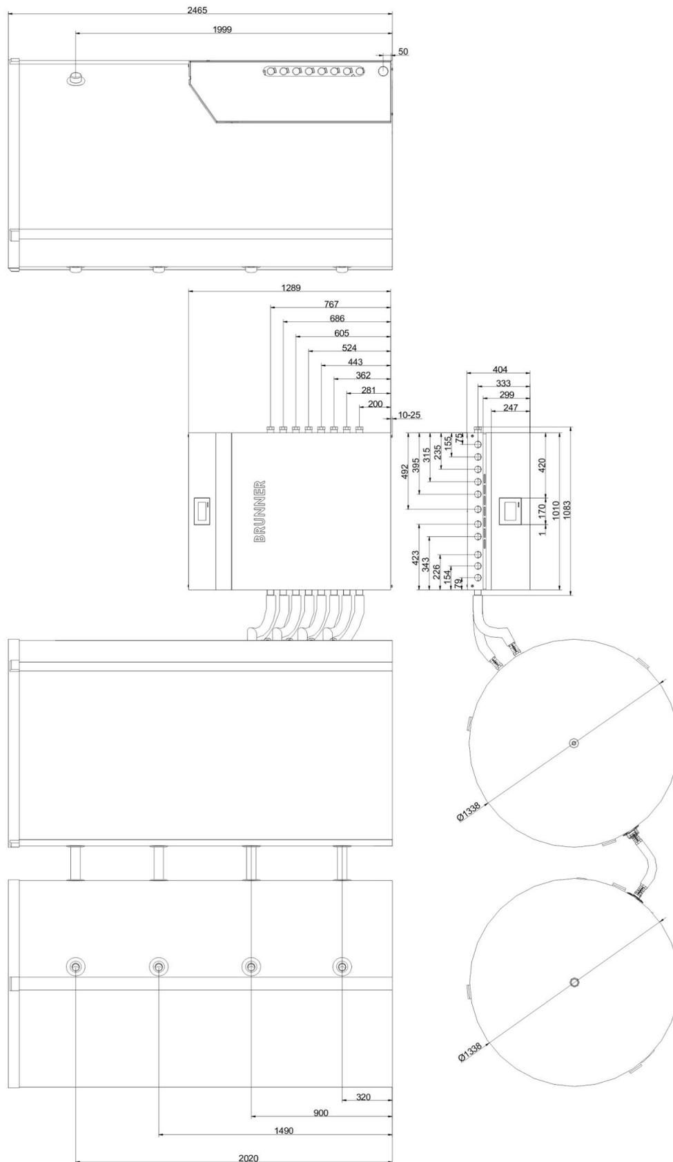
Abbildung 57: BHZ 3.0 mit 2000 I Systemspeicher und 2000 I Standardspeicher
