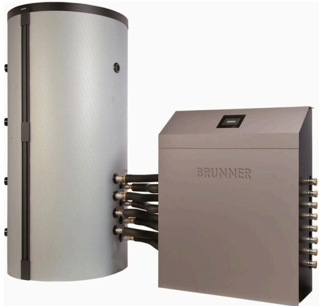
Sämtliche Anschlüsse für Heizkreise, Kessel Vorlauf/Rücklauf, Solar und Warmwasser werden oben aus der Hydraulikbox hinausgeführt. Wenn die Zusatzheizung zum Einsatz kommt, wird Vorlauf und Rücklauf an den seitlichen Sammelrohren 1 und 8 angeschlossen. Die Bauteile, die sich in der Hydraulikbox befinden, sind komplett vormontiert. Optional kann das Touch-Display zur komfortableren Steuerung der Heizzentrale auch im Wohnbereich angebracht werden. Es können bis zu 5 Displays angeschlossen werden.
