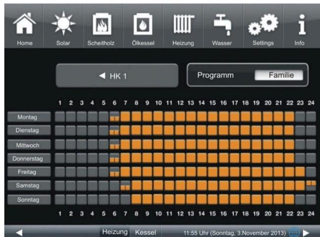
Abbildung 39: Displayansicht am Beispiel für Heizkreis 1
