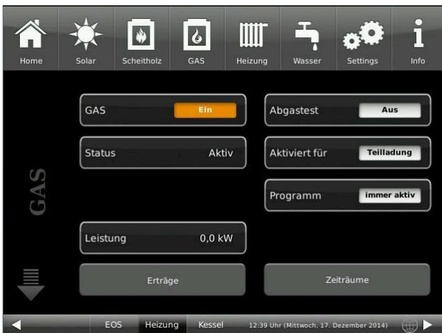
Abbildung 17: 1. Zusatzheizung Gas
