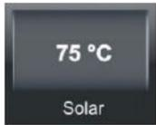
Wenn die Pumpe 1 der Solaranlage inaktiv ist, wird die Kollektortemperatur S 7 angezeigt. Falls ein zweites Kollektorfeld vorhanden ist (Sensor 7 und Sensor 17), dann erscheint nur die Anzeige des heißesten Fühlers.
