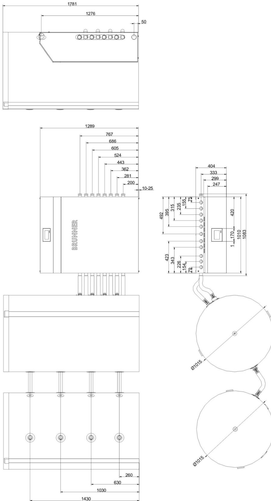
Abbildung 54: BHZ 3.0 mit 750 l Systemspeicher und 750 l Standardspeicher
