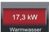
= die Trinkwassererwärmung ist aktiv (Relais A3 **Ein**);
