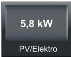
Die von der Photovoltaik-Anlage produzierte Strom wird dem Puffer beigefügt. Der Wert, der in den Puffer übertragene Energie wird aktuell in kW angezeigt.
