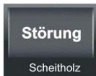
Die Fehleranzeige weist auf eine Störung hin: z. B. wenn keine Wärme geliefert wird, oder es gibt einen Sensorfehler; oder Notbetrieb.
