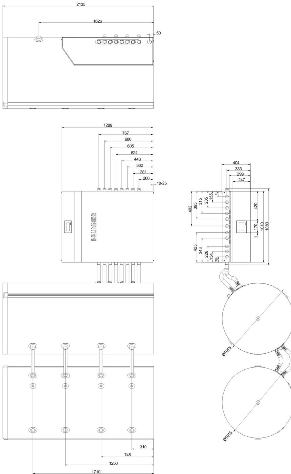
Abbildung 55: BHZ 3.0 mit 1000 l Systemspeicher und 1000 l Standardspeicher
