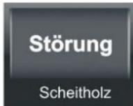
*Störung* entspricht dem Betriebsstatus des Naturkraftkessels *Alarm* oder *Nicht verbunden*
