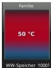
In der *Kopfzeile* der Grafik wird das hinterlegte Programm zur Beladung des Warmwasserspeichers (Boiler) angezeigt. Während des Abwesenheitszeitraumes wird der Status „Aus“ angezeigt.
