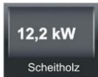
ist die Anzeige der aktuellen Kesselleistung, falls eine Kesselleistung vorliegt.
