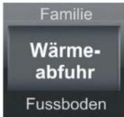
Wenn die Puffertemperatur, unter dem Parameter **T Puffer W weg**, überschritten wurde und der Heizkreis für die Wärmeabfuhr konfiguriert ist, erscheint bei aktivem Status die Anzeige der Wärmeabfuhr für den betreffenden Heizkreis
