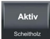
*Aktiv* oder die Leistungsangabe entspricht dem Betriebsstatus des Naturkraftkessels *Anheizen, Abbrand*, oder *Glutüberwachung*, aber es existiert keine Leistung.
