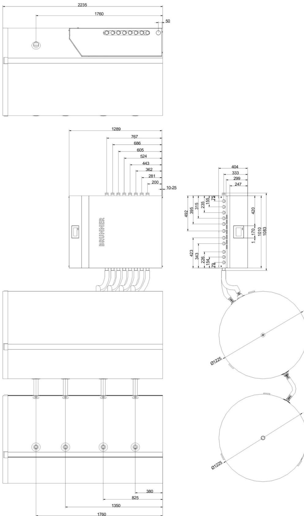
Abbildung 56: BHZ 3.0 mit 1500 l Systemspeicher und 1500 l Standardspeicher
