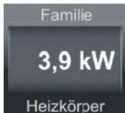
= In Abhängigkeit vom Parameter **Anzeigemodus** (ab Werk eingestellt auf 30 Sek.) (befindet sich unter Menü **Heizkreis** / (2. Seite) **Anzeigemodus**) wird zwischen der Temperatur- und Leistungsanzeige automatisch gewechselt.
