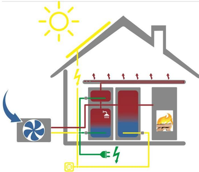
Wärmemanagement der nächsten Generation – Wärmepumpe kombiniert mit einem wasserführenden Holzbrandofen oder Kamin.
