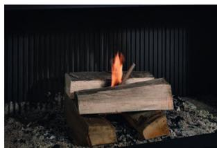
Treten Rauchgase durch Querströmefekte im Raum aus, kann der heruntergezogene Funkenschutz Besserung bringen. Die Gitterstruktur reduziert die freie Querschnittsfläche um ca. 1/3 und „bricht“ die Luftwirbel wie bei einem Windschutznetz.
