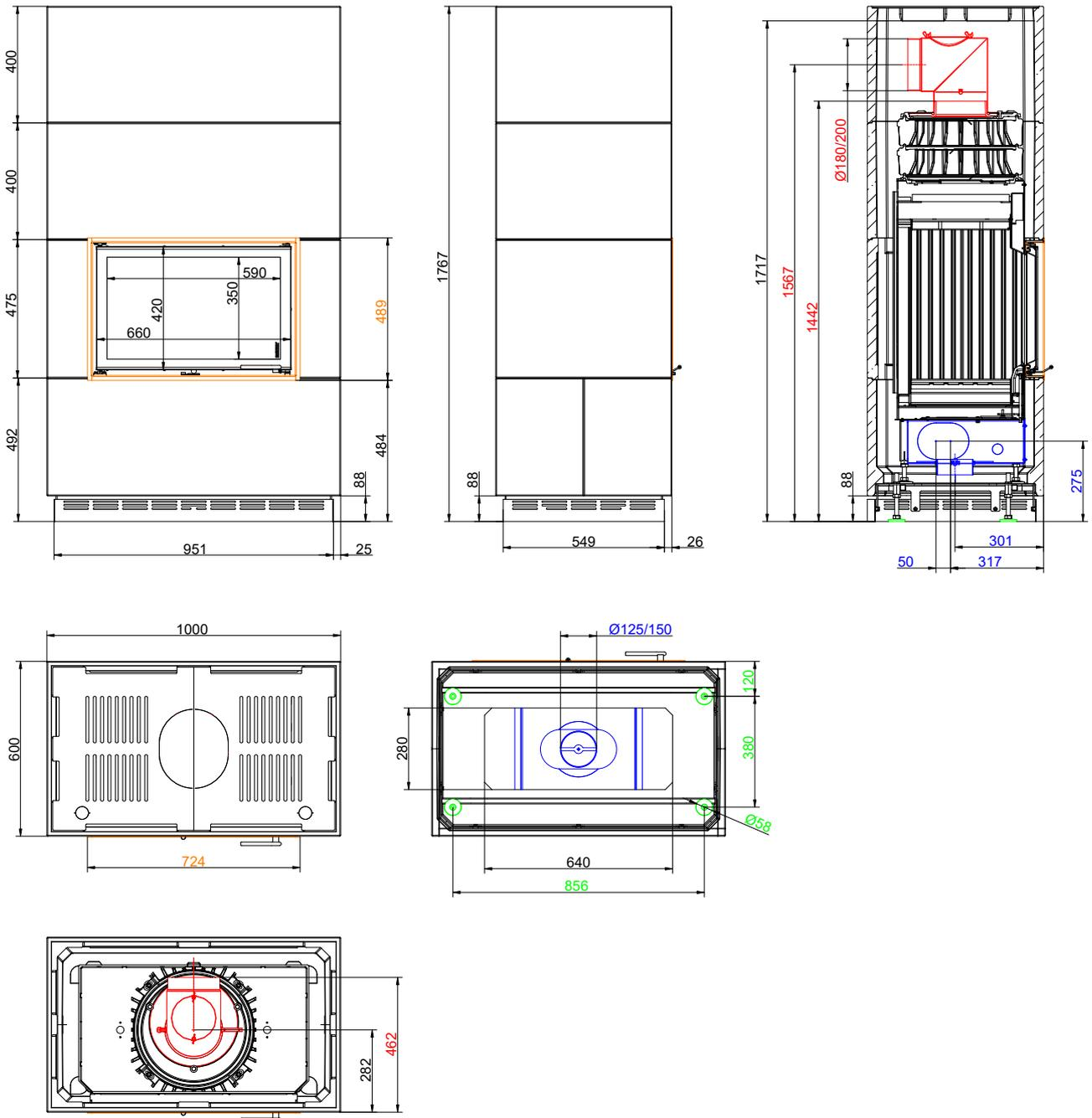
... mit Drehtür Rahmen (orange), Verbrennungsluftstutzen (blau), Sockelfüße (grün) farblich markiert
